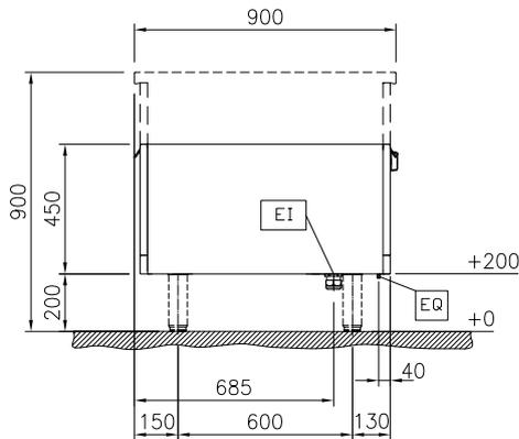
EI = Conexión eléctrica (energía)
